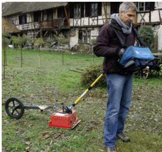
Stefan Giese am Schlössli bei der Arbeit mit dem Boden-Radar | Foto: Oehler
